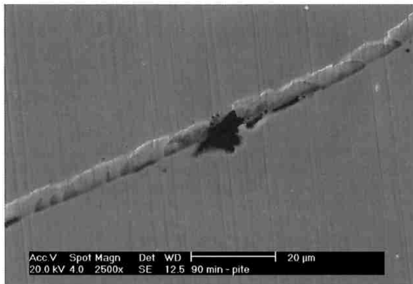
Figura40: Micrografia da condição tratada termicamente a 600°C por 90 min após técnica potenciodinâmica. Nota-se o pite formando-se nos contornos de grão.
