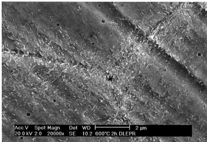
Figura 28: Micrografia da condição tratada termicamente a 600°C por 2horas após DL-EPR. O aumento de 20000x mostra que o material apresenta-se recuperado.
