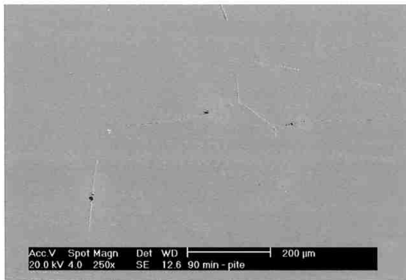
Figura 39: Micrografia da condição tratada termicamente a 600°C por 90 min após técnica potenciodinâmica. Nota-se o pite formando-se nos contornos de grão.
