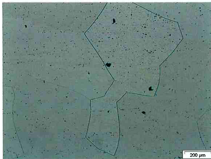
Figura 2: Micrografia para a condição solubilizada após Prática W. Notam-se grãos recristalizados de ferrita, valas em contorno de grão e contornos de grão não atacados. Além disso, observam-se também inúmeros pites de ataque. MO.
